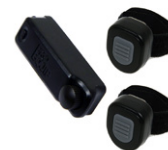
PRO-1-Wire 2G adapter 2 x wireless PTT 1-wire for tilkobling av headset inkl 2 stk trådløse PTT
