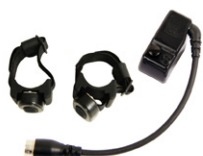
Hiroseadapter + 2x wireless PTT, 12-pin Adapter til STP med 2 stk trådløse PTT
